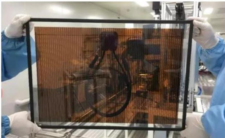
图：纤纳半透明α组件，透光度可调节
